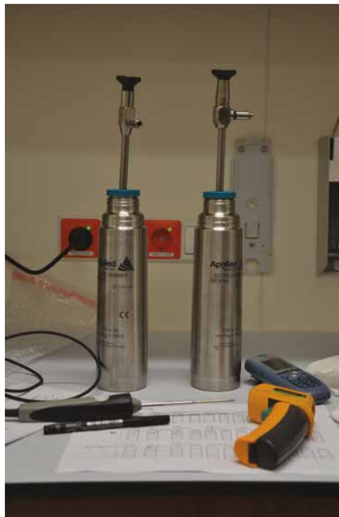
Afbeelding 3 De scoop werd verwarmd in een thermoskan met steriel warm water.
