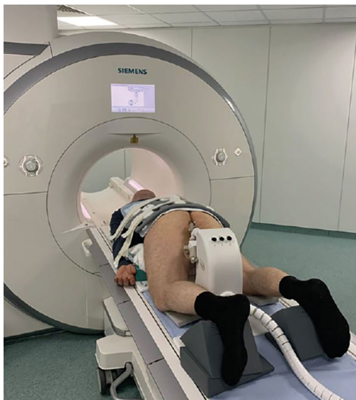
Figuur 1 MRI-gestuurde prostaatbiopsie met 'remote controlled manipulator'. Opstelling in de MRI-ruimte waar patiënt in buikligging gepositioneerd is. De robot voor de prostaatbiopsie bevindt zich tussen de benen van de patiënt.
