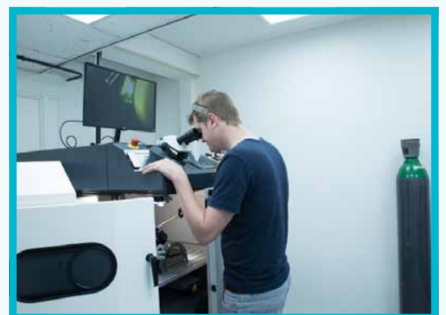
Met behulp van laserlas technologie wordt RFID aangebracht. Foto: Van Straten Medical.
