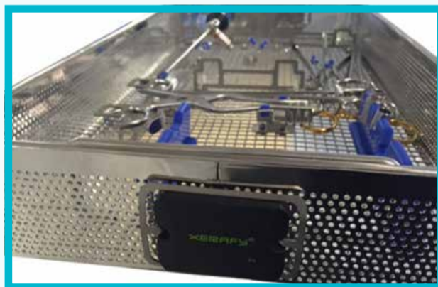
Instrumentnetten door Van Straten Medical voorzien van autoclaveerbare RFID tags. De netten worden via zogenaamde 'readers' tot op 8 meter afstand uitgelezen.
