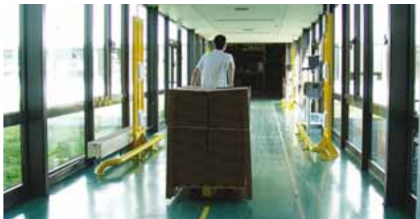
Afbeelding 1: Een speciale poort leest de RFID-chips uit.
